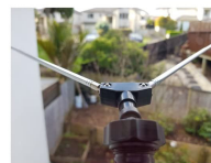
Dipol w kształcie V do odbioru satelity
