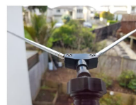
Dipol w kształcie V do odbioru satelity
